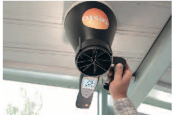
testo 417, z.B. zur Kontrolle der Zuluft an einem Tellerventil
